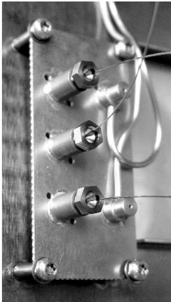
图1. 6890N GC中的新微汇流Deans切换的连接图
